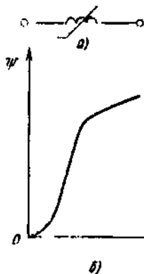
Рис. 4.2. Условное обозначение идеализированной нелинейной катушки индуктивности (а) и ее вольт-амперная характеристика (б)
